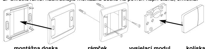
RF vysielač môže byť priradený k existujúcim domovým spínačom, pričom je potrebné použiť viacnásobný vertikálny rámk
